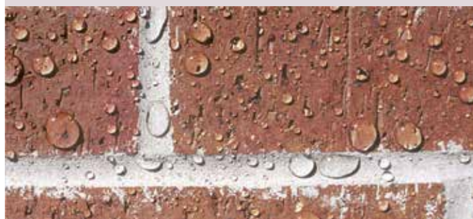
эффект «стоячей капли» при гидрофобизации
